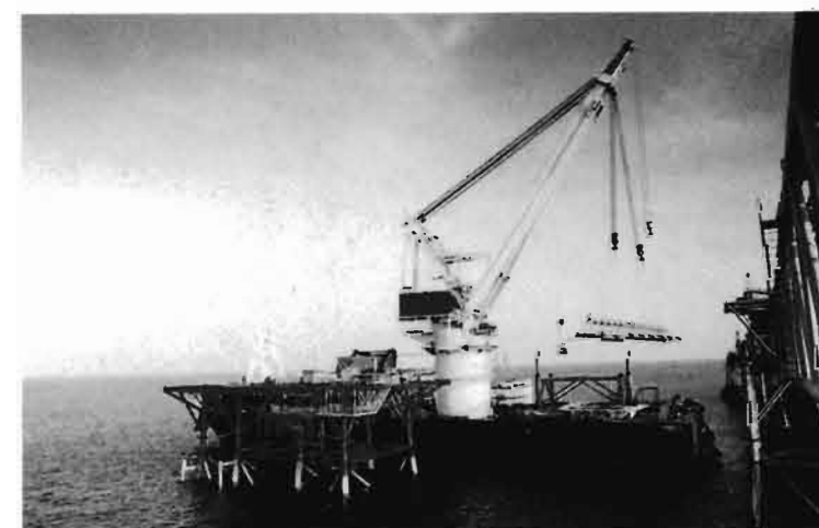
● Tàu cầu Trường Sa sức nâng 600 tấn ● Crane vessel Truong Sa with 600 tons lifting capacity
