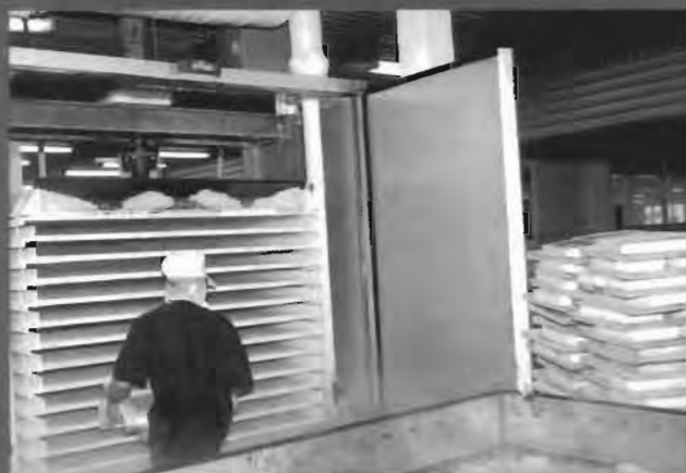
▲ Tủ đông công suất 1 tấn/mẻ Contact freezer 1 M/T per shift
