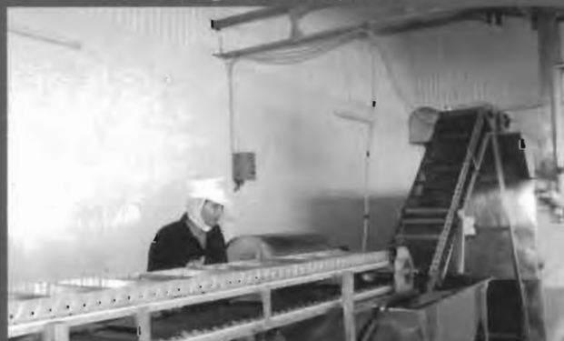
Băng chuyền luộc công suất 1 tấn/giờ Boiling belt 1 M/T per hour ▼
