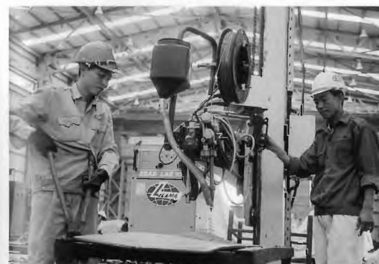
Máy hàn bồn tự động. Automatic tank welding machine.
