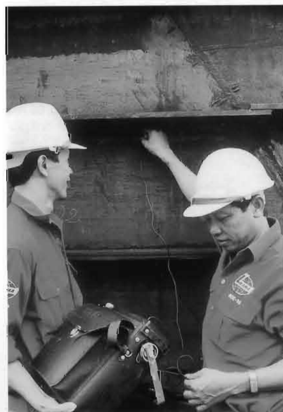
Kiểm tra chất lượng mối hàn bằng các thiết bị tiên tiến Testing for quality of welded joints with advanced and modern equipment.
