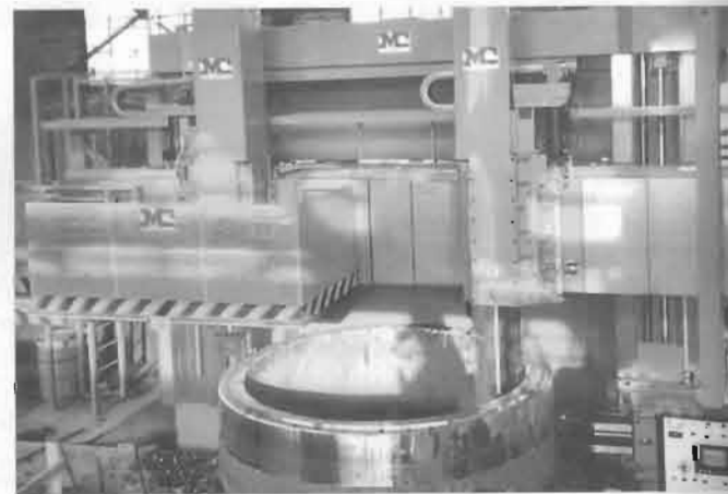
Máy tiện đứng CNC lập trình Simen Sinumerik- 8400 đường kính gia công 4000mm, chiều cao phôi tiện 2000mm.
