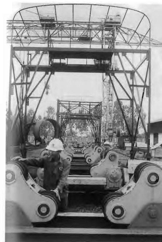
Bộ gá quay dùng trong công nghệ hàn các thân ống lớn: như lò nung xi măng... Rotating clamp set for welding giant pipe bodies like cement kiln.
